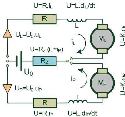
Fig. 6 Motors wiring
